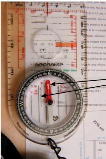
Le Nord magnétique du schéma de la carte coïncide avec le nord magnétique de la boussole -> la carte est correctement orientée
